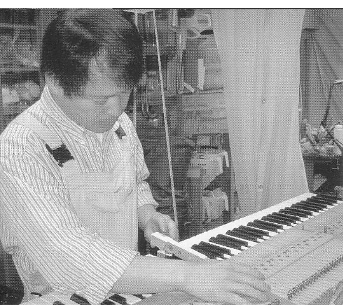
鍵盤の重さを鉛で調整。鍵盤は重すぎても軽すぎても弾きづらい。このためお客様の意向に従って鍵盤が下がるときと上がるときの重さを測定しつつ、調整する。
